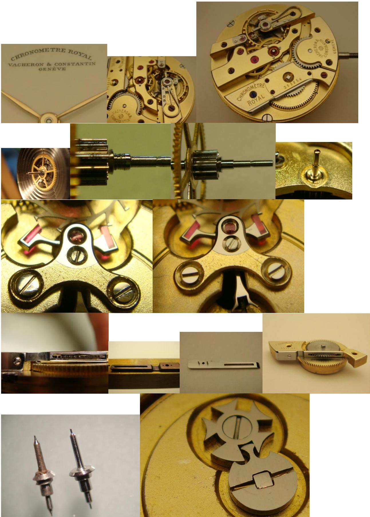
Projekt mit 48.75 Arbeitsstunden (u.a. Anfertigen von: Stellungsfinger, Unruhwelle, Sperrfeder, Minutenradlager, ...).
