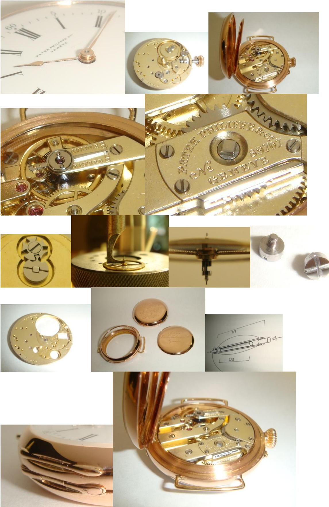
Projekt/Fertigstellung im Jahr 2014 mit 55.50 Arbeitsstunden (u.a. Anfertigen von: Werkbefestigungsschrauben, Stellungsfinger, Stellungskreuz, Scharnierendkeile, Zylindertampons, ...).
