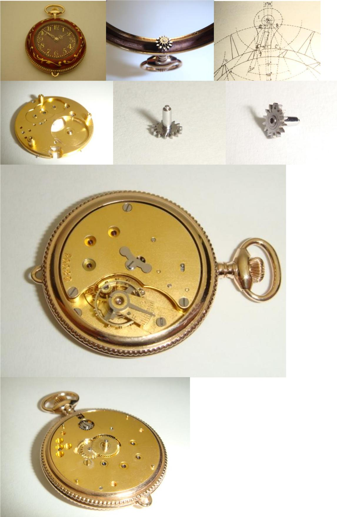
Projekt/Fertigstellung im Jahr 2012 mit 32.00 Arbeitsstunden (u.a. Anfertigen von: Lagerstift für Viertelrohr, Viertelrohrwelle, Zahnkranz, ...).
