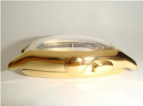
Projekt/Fertigstellung mit 73 Arbeitsstunden (u.a. Anfertigung von: 18kt Krone, 18kt Drücker bei „2“, Lagerbuchse für Aufzugswellenführung, Aufzugswelle, Kupplungsfeder für Chronograph, Unruhwellen, Minutenzählradraste ergänzen, zweiseitig gewölbtes Mineralglas einschleifen lassen, ...).
