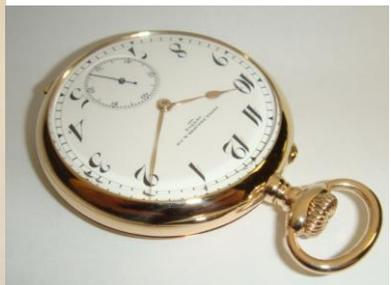
U.a. Stellungsfinger erneuert, Oxydationsspuren entfernt, Schrauben aufgearbeitet, ... usw.
