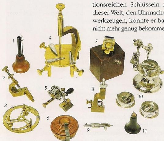
1. automatischer Ölgeber, 2. Senkspiel, 3. Werkhalter, 4. Geradebohrmaschine, 5. Bügelfräsmaschine, 6. Holzauflageringe, 7. Unruhwaage, 8. Viertelrohrverengmaschine, 9. Vergleichsmaß, 10. Spiralabzählmaschine, 11. Steinlupe
