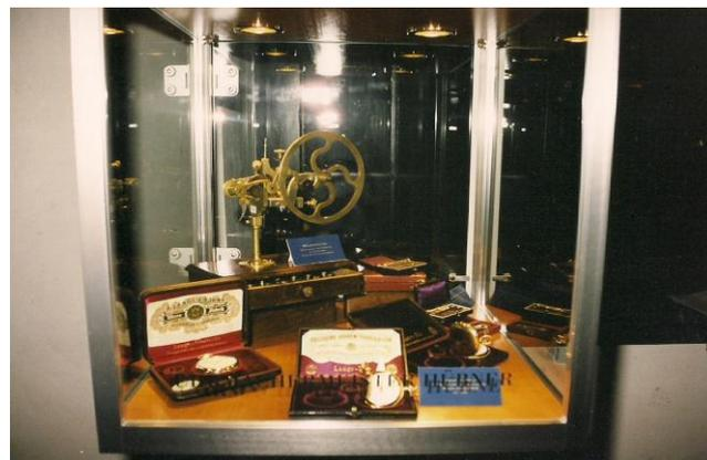
Klammerdrehbank / Zapfenbohrmaschine
